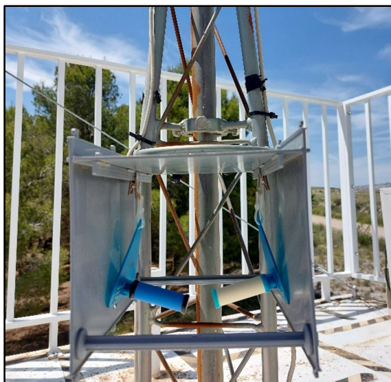
Figura 3. Instalación de Pasivos Radiello Fuente: Propia
