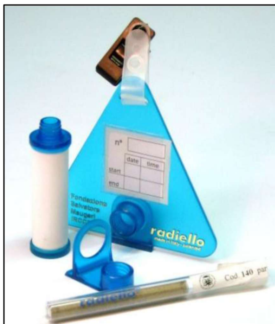
Figura 2. Sistema de muestreo Pasivos Radiello Fuente: Manual Radiello
