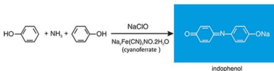
Figura 2. Principio de determinación de amoníaco en Pasivos Radiello
