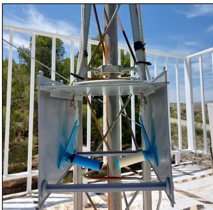
Fotografía 1. Instalación de Pasivos Radiello
