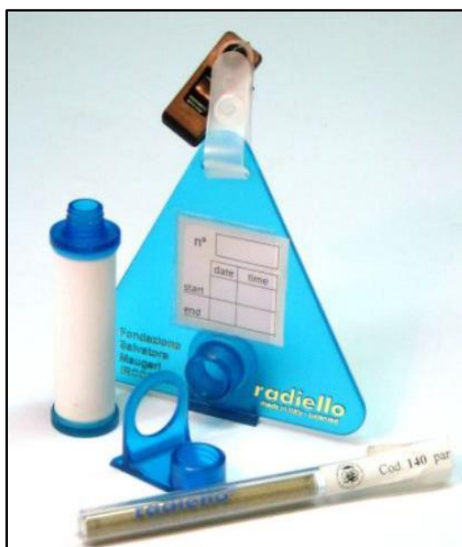
Figura 1. Sistema de muestreo Pasivos Radiello
