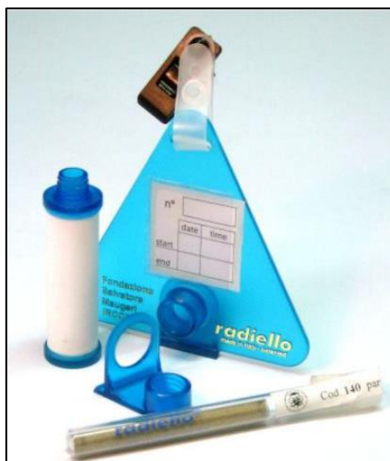
Figura 3. Sistema de muestreo Pasivos Radiello Fuente: Manual Radiello
