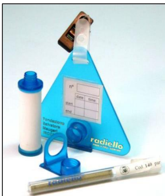
Figura 4. Sistema de muestreo Pasivos Radiello Fuente: Manual Radiello
