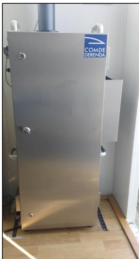
Figura 8. Captador Gravimétrico Derenda PNS-18T-DM Fuente: Propia
