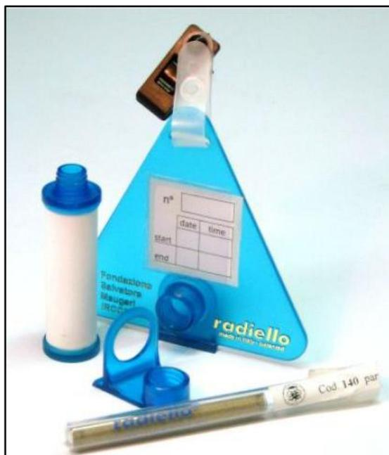
Figura 3. Sistema de muestreo Pasivos Radiello
