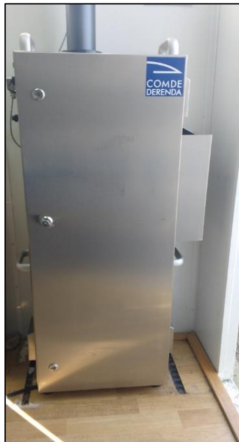
Figura 8. Captador Gravimétrico Derenda PNS-18T-DM Fuente: Propia
