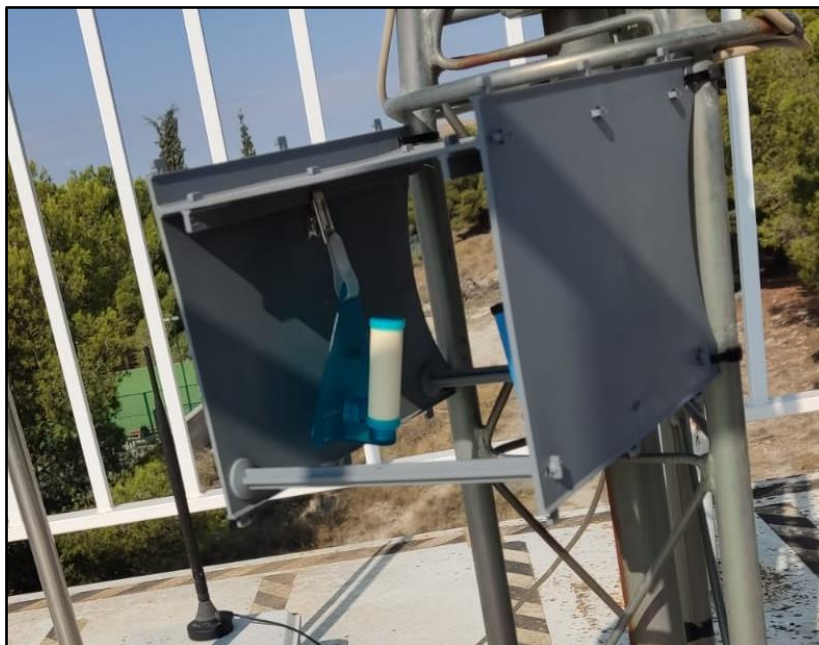
Figura 4. Instalación de Pasivos Radiello Fuente: Propia
