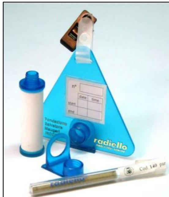
Figura 2. Sistema de muestreo Pasivos Radiello
