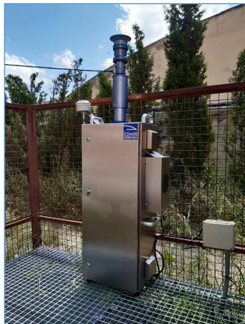
Se ha completado el equipamiento, con la adquisición en el mes de noviembre de un monitor de partículas para la medición en continuo del material particulado PM10.
