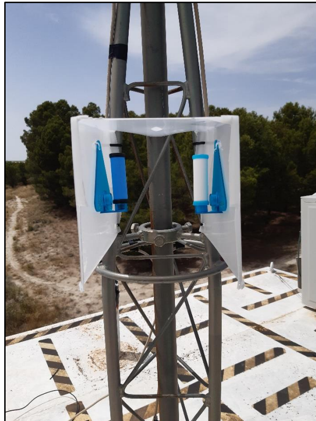
Figura 4. Instalación de Pasivos Radiello Fuente: Propia
