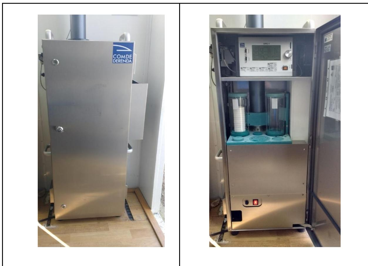
Figura 8. Captador Gravimétrico Derenda PNS-18T-DM
