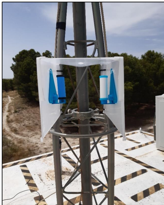
Figura 2. Instalación de Pasivos Radiello Fuente: Propia
