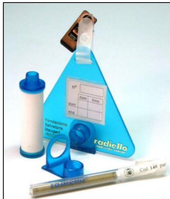
Figura 3. Sistema de muestreo Pasivos Radiello Fuente: Manual Radiello 2019
