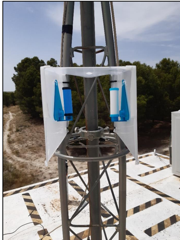
Figura 3. Instalación de Pasivos Radiello Fuente: Propia
