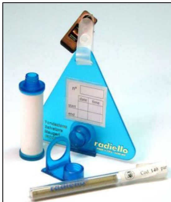
Figura 2. Sistema de muestreo Pasivos Radiello Fuente: Manual Radiello 2019
