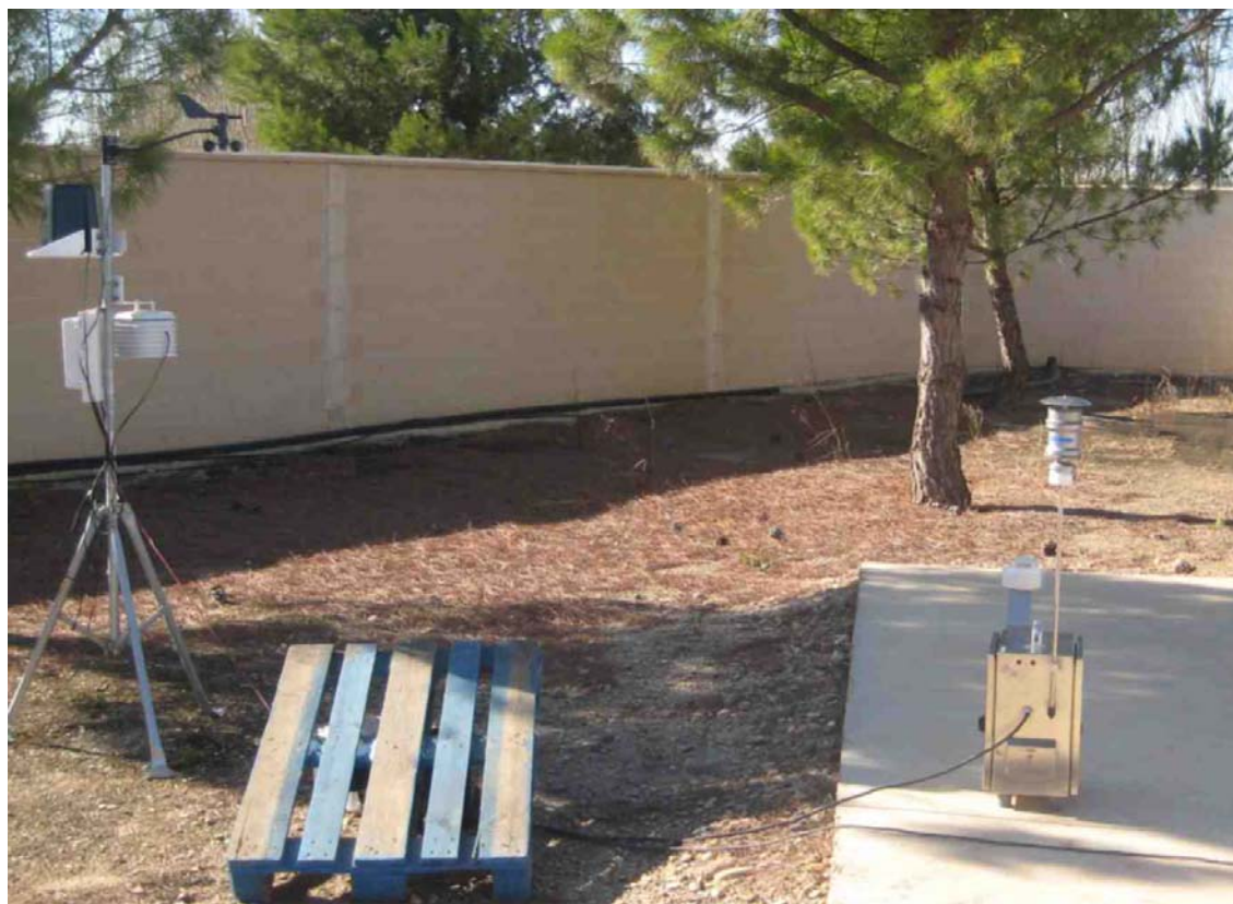
Figura nº51: Fotografía del captador y la torre meteorológica
