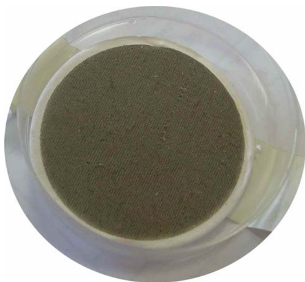
Figura nº3: Estado correcto del filtro una vez realizado el muestreo
